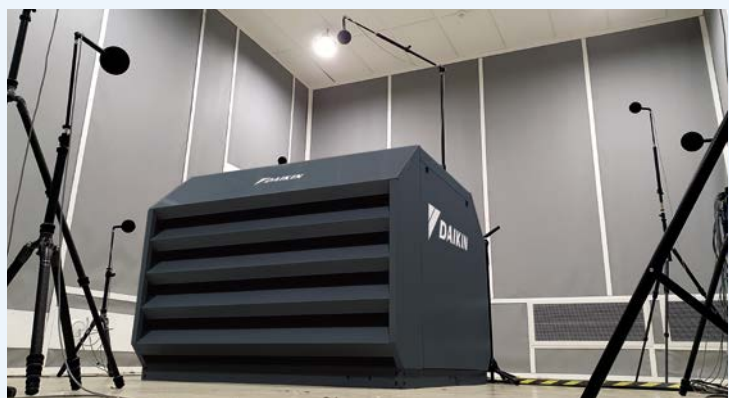
Pomiar poziomu mocy akustycznej w komorze akustycznej
