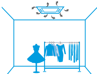
Rozkład powietrza z zabrudzonym filtrem
